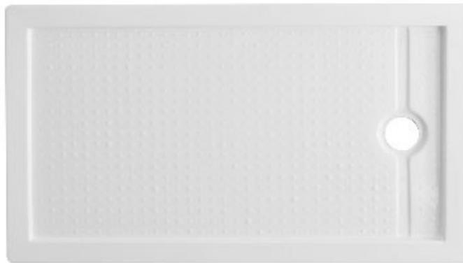
Una delle criticità dei piatti doccia in Acrilico risiede nell'installazione in quanto, essendo un prodotto plastico vuoto nella parte sottostante, necessita di essere messo in opera tramite apposita schiuma poliuretana che va necessariamente inserita in maniera uniforme per tutta la superficie di appoggio in linea con il pavimento in modo da evitare “vuoti” che con il tempo potrebbero causare avvallamenti o rotture.
